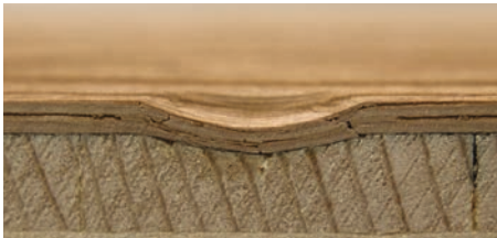
Herkömmliches Parkett mit Fichte-Mittellage (Deckschicht Eiche 3,6 mm)
